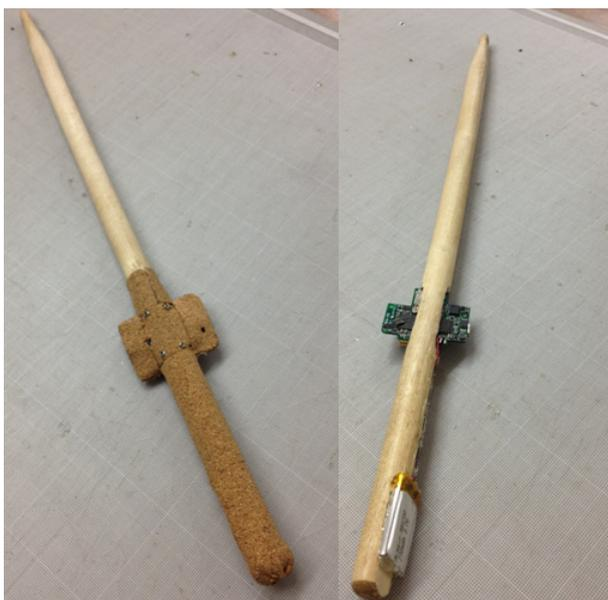
図7 Airstic Drum のプロトタイプ
