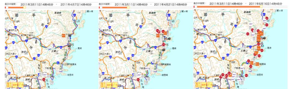
図 11 各移動通信業者における復旧状況の時系列表示
