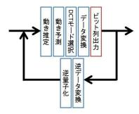
図 2 MPEG-2 エンコーダの 1 フレームに対する処理
