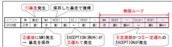
図3 CPUの暴走が継続するパス
