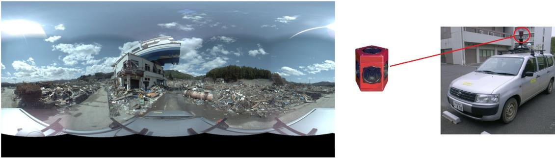
図 1 左：取得した全方位画像の例。右：撮影車の全景。Point Grey Research 社の全方位カメラ Ladybug3 と GPS センサを搭載する。路上約 1-2m につき 1 枚の全方位画像を、走行中に撮影する。
