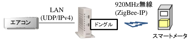
図 2 2つのサブネットにまたがる HEMS の例
