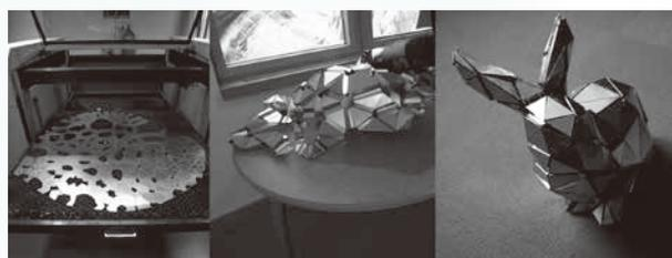
図-1 スチール板のレーザカッティングと、折り曲げによる Stanford Bunny (T. Tachi, K. Cheung, E. Demaine, M. Demaine)
