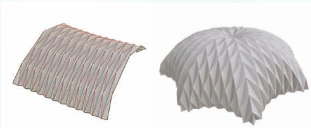
図-3 折紙による円筒型形状 (吉村パターン: 左) とそれを応用した椀型曲面 (右)
