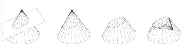
図-11 可展面の鏡映反転による曲線折りの作成
