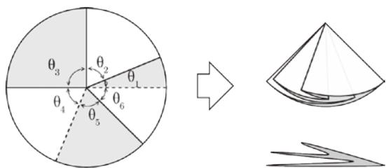
図-18 折り畳める頂点の条件. 灰色に塗った角の符号を反転させて角度をたすと0となる. また,山折り(実線)と谷折り(破線)の数の差は2である
