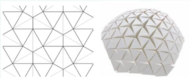
図-4 折紙による椀型曲面 (Reschによるパターン)
