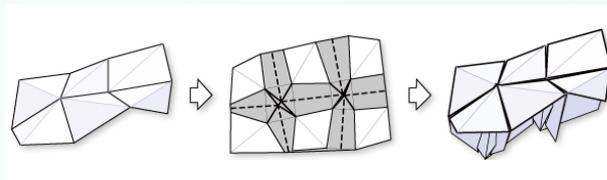
図-9 ヒダを折ることで元の3次元形状が再現される
