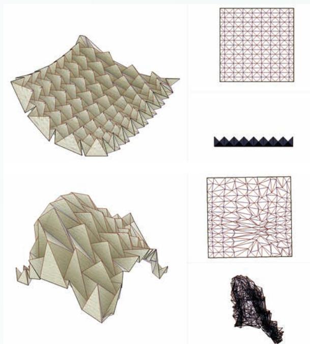
図-19 折り畳み条件を満たした自由変形. 上:「なまこ」, 下:自由変形. 右画面は展開図と, 平坦に折られたときの形を示す
