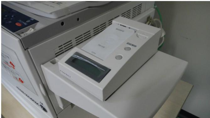
図 7 IC カード認証式オンデマンド印刷用プリンタ
