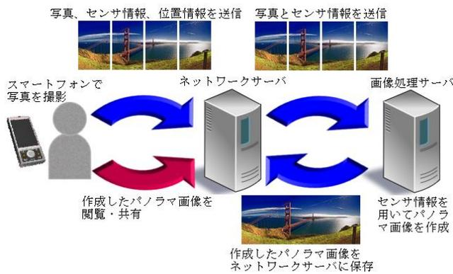
図 3 提案システムの概要図
