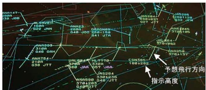
図-5 管制卓上に表示された航空交通流の例
