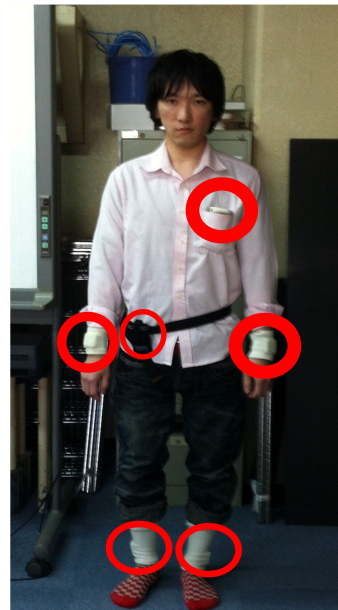
図 5 ウェアラブルセンサの装着図 Fig. 5 Wearing of wearable sensors
