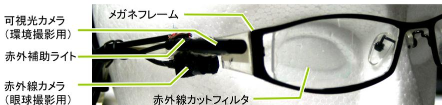
図5 常用可能性を考慮した視線認識装置。赤外カットフィルタにより反射する眼球の赤外映像を利用して視線方向を測定する
