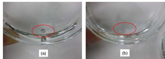
図8. (a)は、透明樹脂(屈折率1.4)が入っているシャーレに蛍光体ガラス(屈折率2)を入れたときの写真。(b)は、同じ透明樹脂が入っているシャーレに合成石英ガラス(屈折率1.45)を入れたときの写真。合成石英ガラスの存在は、目視で確認しにくいことがわかる。
