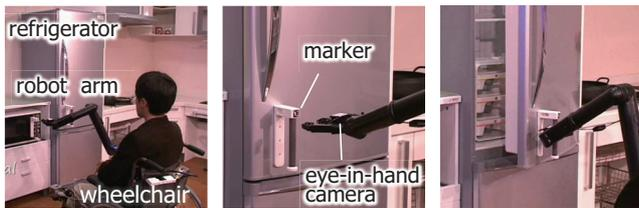
図 23 Autonomous door handling using visual marker
