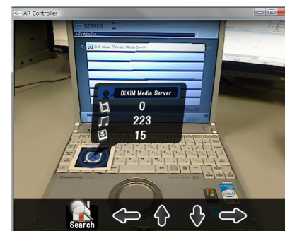
図 6 デバイス情報の AR での表示 1 (PC A) Fig. 6 Display of the Device Information using AR 1 (PC A).
