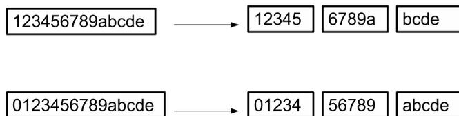
図 3 1 バイト付加したファイルのブロック分割 (ブロックサイズ 5bytes)
