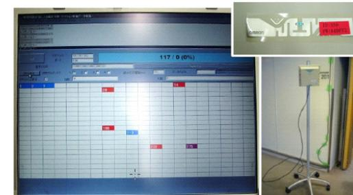
図 5 左: RFID 制御ソフトウェア表示画面, 右上: RFID タグ (V750-D22M01-IM), 右下: RFID アンテナ (V750-HS01CA-JP)
