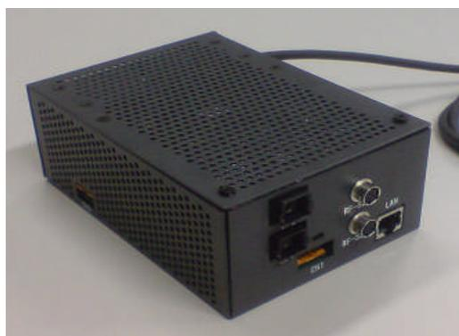
図 4 車車間通信機外観
