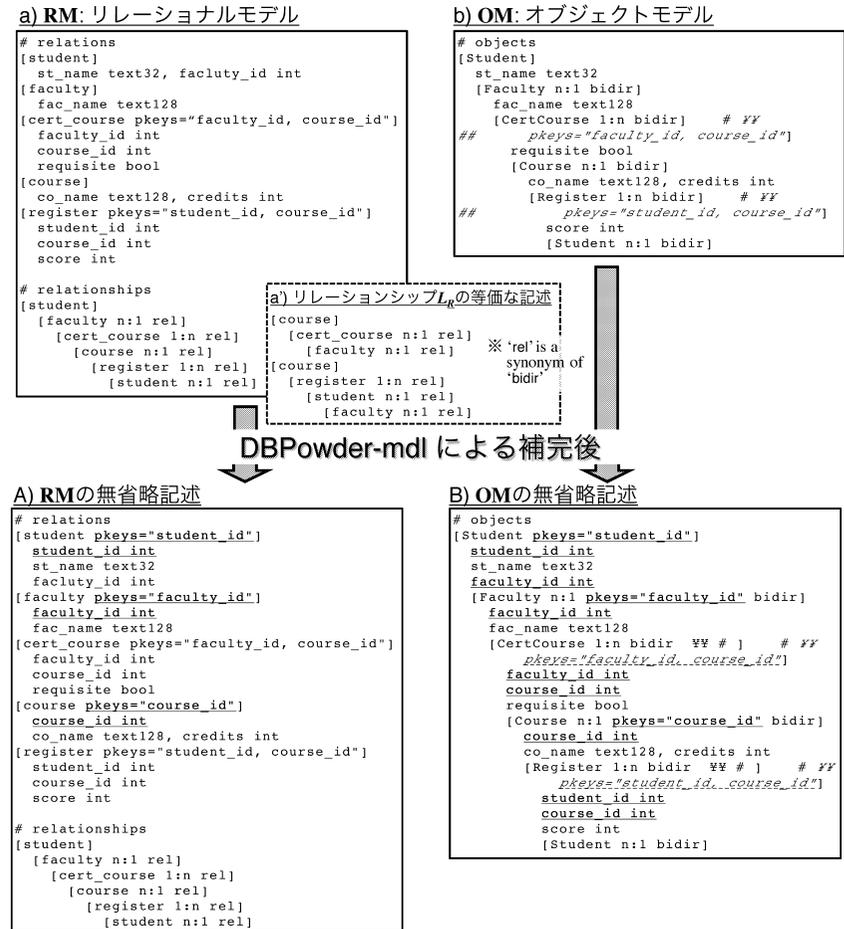
図 12 DBPowder-mdl 記述例 3 : 学科-生徒-履修-科目スキーマ
