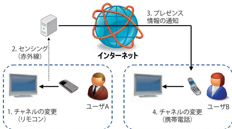
図-5 実空間プレゼンスサービスの一例。テレビのリモコンの制御情報を赤外線受信機でセンシングし、テレビの視聴情報を友人と共有する。たとえば、ユーザーAがリモコンでチャンネルを変更するとユーザーBが閲覧している番組も変更される。仮想空間のプレゼンスサービスよりも、より「つながっている感」を演出することができる。
