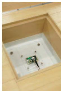
図-3 地震モニタリング。地震による振動を建物に埋め込まれた加速度センサで計測する。耐震技術の基盤である地震モニタリングを低コスト・高密度化したいという要求は強く、有線敷設が不要な無線センサネットワークでシステムを構築することの意義は大きい。
