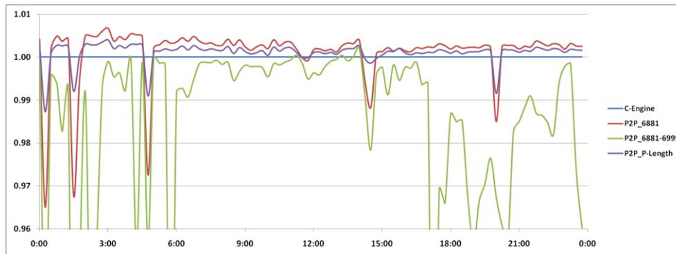
図 11: C-Engine を基準とした際の各手法におけるキャッシュヒットレート
