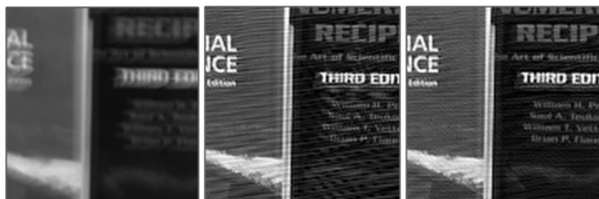
(a) ぶれ画像 (b) フーリエ変換による復元 (c) リンギング除去
