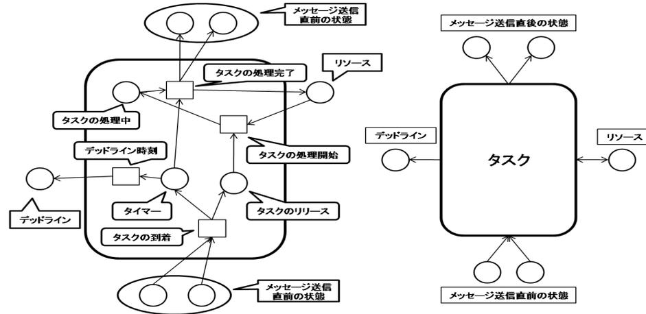
図 5 タスクの性能検証モデル
