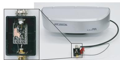
図 10 評価実験用試作レクテナ外観
