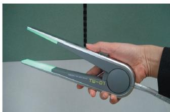
図3 ピンセット型デバイスの外観
