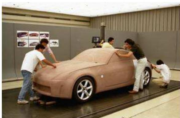
Fig.2 実物大クレイモデルでのデザイン開発
