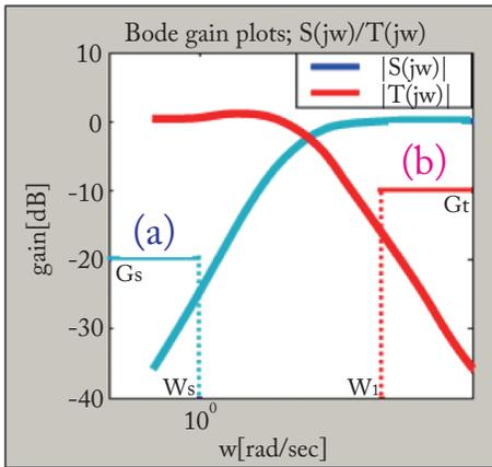
図-5 ボーデ線図における感度・相補感度の制約
