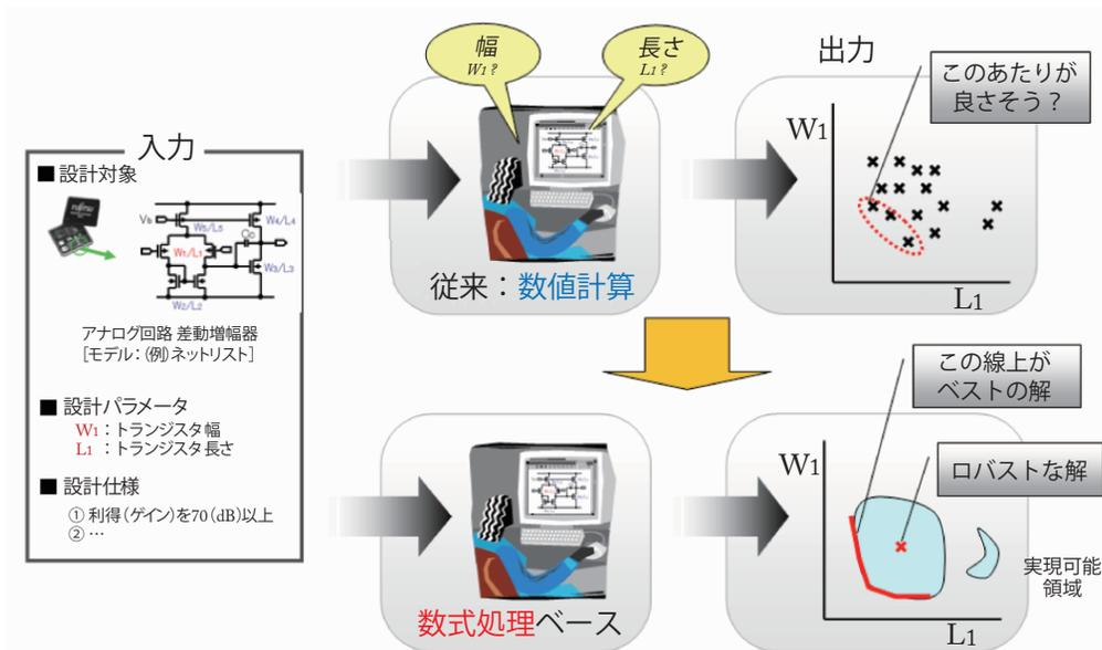
図-1 数式処理を用いた設計最適化
