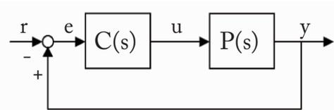
図-4 フィードバック制御系
