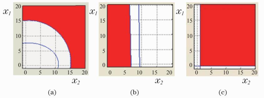
図-6 各仕様に対する  $x_1, x_2$  の実行可能領域
