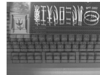
図2 2重反射像の例
