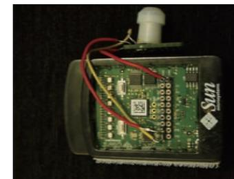
図 3 SunSPOT への焦電センサ実装
