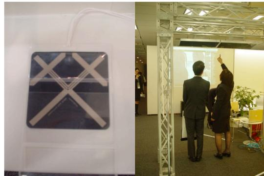
図2：UHF帯のICタグとリーダ
