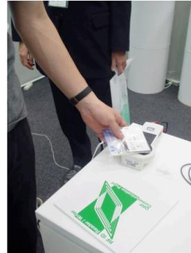
図1：HF帯のICタグとリーダ
