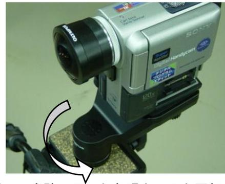
図9. 実験に用いた魚眼カメラと回転台
