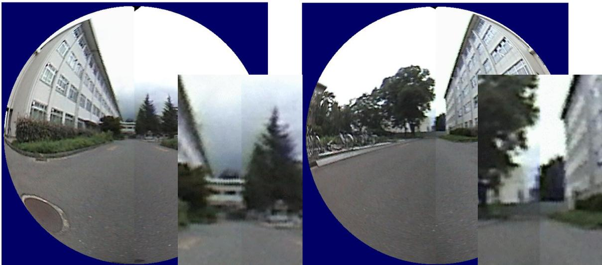
図 1 2. 試作した実時間全天周球面画像撮像装置による屋外シーンの実験結果.
