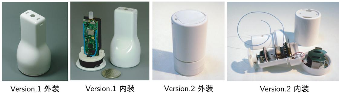
図 1: 携帯型組み込みセンサノード@reader
