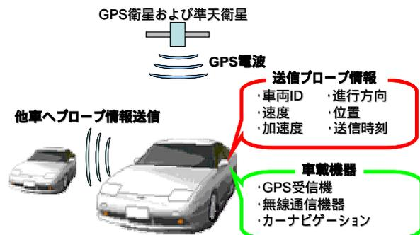
図 1. 車両情報と搭載機器
