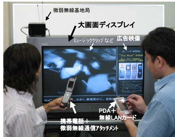
図 6 試作システム外観
