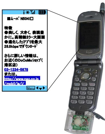
図 9 携帯電話に接続した微弱無線通信アタッチメント
