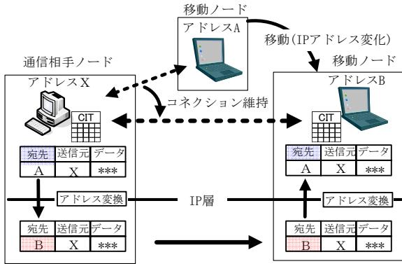
図 5 アドレス変換の例
