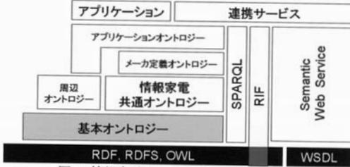
図1 情報家電オントロジーの階層構造
