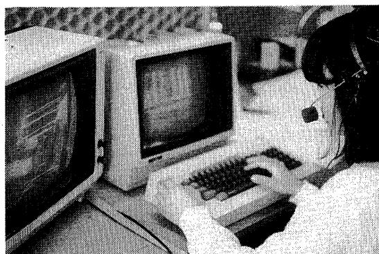
図4 単音節音声タイプライタの外観
