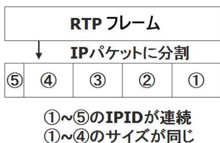
図3 RTP フレームの IP パケット化
