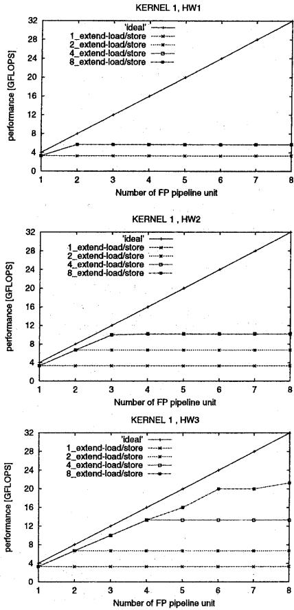
図2 livermore kernel "KERNEL 1" の性能評価結果
