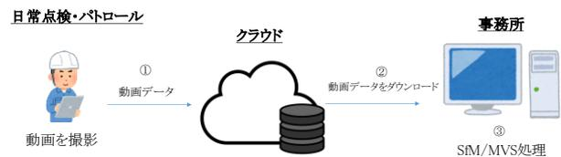
図2 3次元点群データ計測方法
