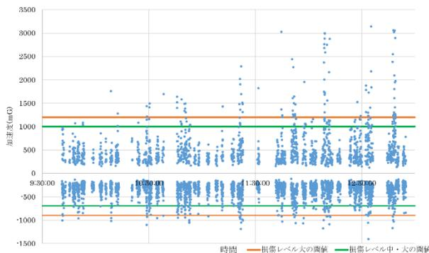
図4 2020年8月20日走行車両の加速度データ
