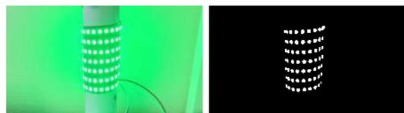
図3. 左:白色照明をつけた室内で、輝度を50に設定して撮影した画像, 右:画像の2値化を行い、発光しているLEDの部分を抜き出した画像
