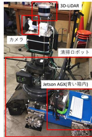
図1: 自律走行ロボットの外観と搭載装置
