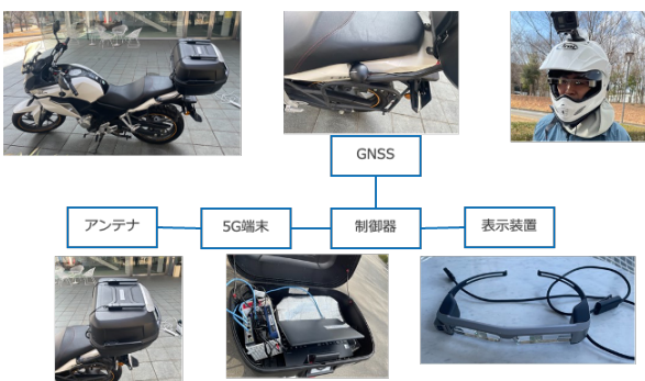
図 11 バイクの機器設置状況と構成
