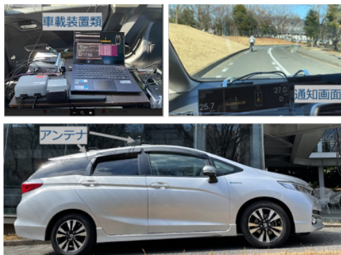
図 9 自動車の機器設置状況
