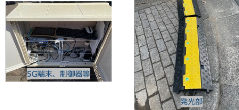
図 12 グラウンドライトの外観と機器構成
