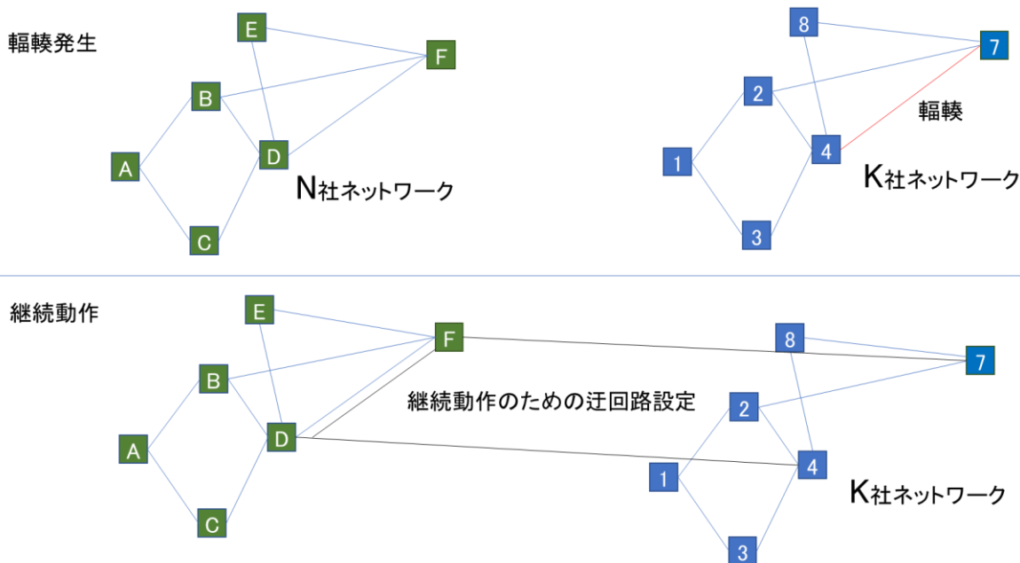
図5 2社ネットワークからなるシステムの輻輳制御における Double 指向の3つの機能による継続動作へ向けた制御
