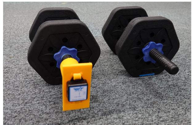
図 1 ダンベル側面に装着した 9 軸加速度センサによりトレーニング種目と利用者を自動推定するスマートダンベル。
