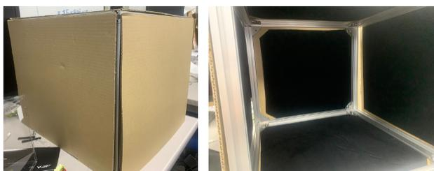
図4：作成したミニ暗室(390×370×310[mm])
