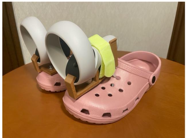
図5 Oculus Quest2 コントローラ 穴あきサンダルアタッチメントにコントローラを装着し、面ファスナーベルトで固定した様子
