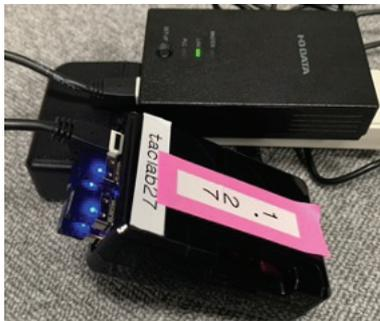
図 2 BLE アダプタを 4 つ増設した Raspberry Pi
