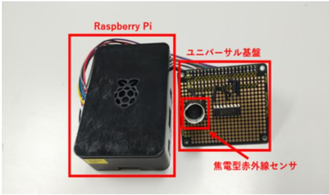
図 1 脚部動作計測デバイス
